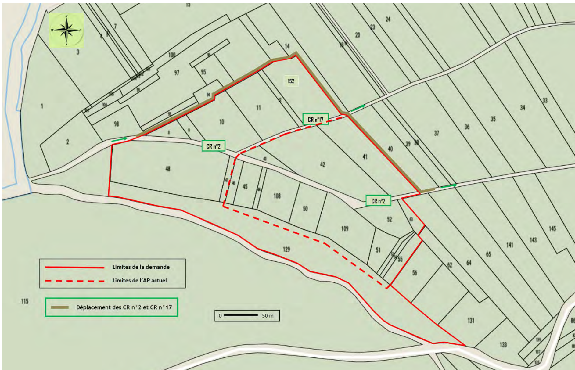
Figure 13 : Déplacement des chemins ruraux n° 2 et 17
